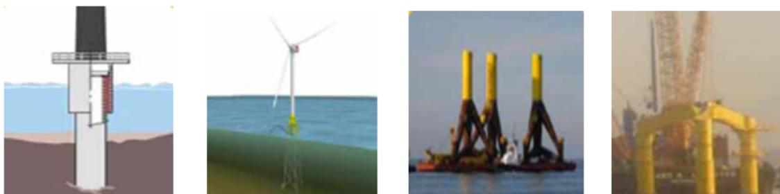
**Figura 53.- Distinto tipo de cimentaciones utilizadas para los parques eólicos offshore. De izquierda a derecha: El monopilote, jackets, tripodes y multipilotes.**
