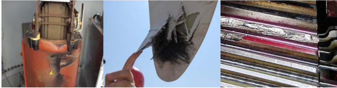
Figura 78.- Distintos siniestros debido al mal aislamiento, al impacto de un rayo y la degradación de las ruedas dentadas.
