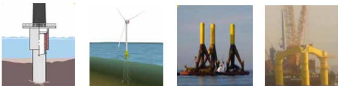
Figura 53.- Distinto tipo de cimentaciones utilizadas para los parques eólicos offshore. De izquierda a derecha: El monopilote, jackets, trípodes y multipilotes.
